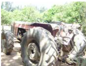
Trator sem proteção para o condutor
